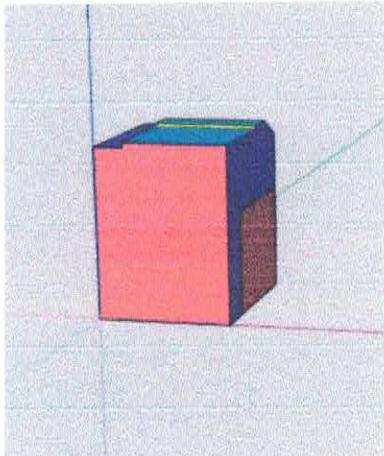
Le volume protégé d'un logement reprend tous les espaces du logement que l'on souhaite protéger des déperditions thermiques que ce soit vers l'extérieur, vers le sol ou encore des espaces non chauffés (cave, annexe, bâtiment mitoyen...). Il comprend au moins tous les locaux chauffés. Lorsqu'une paroi dispose d'un isolant thermique, elle délimite souvent le volume protégé.
