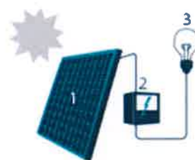
1. Zonnepaneel | 2. Omvormer | 3. Elektrische installatie
