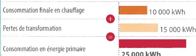
A l'inverse, en cas d'auto-production d'électricité (via panneaux photovoltaïques ou cogénération), la quantité d'énergie gagnée est aussi multipliée par 2,5 ; il s'agit alors de pertes évitées au niveau des centrales électriques.
