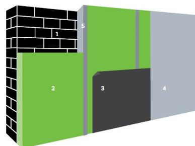
1. Buitengevel | 2. Isolatie | 3. Dampscherm | 4. Binnenaanwerking | 5. Stijl- en regelwerk (optioneel)
