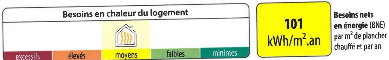
Ces besoins sont les apports de chaleur à fournir par le chauffage pour maintenir constante la température intérieure du logement. Ils dépendent des pertes par les parois selon leur niveau d'isolation thermique, des pertes par manque d'étanchéité à l'air, des pertes par la ventilation mais aussi des apports solaires et des apports internes.
