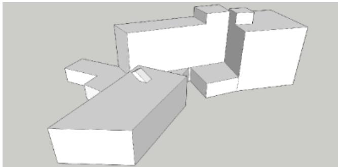
Le volume protégé d'un logement reprend tous les espaces du logement que l'on souhaite protéger des déperditions thermiques que ce soit vers l'extérieur, vers le sol ou encore des espaces non chauffés (cave, annexe, bâtiment mitoyen...). Il comprend au moins tous les locaux chauffés. Lorsqu'une paroi dispose d'un isolant thermique, elle délimite souvent le volume protégé.
