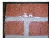
Application de l'essai sur la brique rouge avec apparition d'efflorescences (voile et cristaux ternés).
