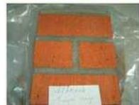
Application de l'essai sur la brique orange sans apparition d'efflorescences.
