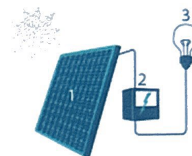
1. Zonnepaneel | 2. Omvormer 3. Elektrisch apparaat
