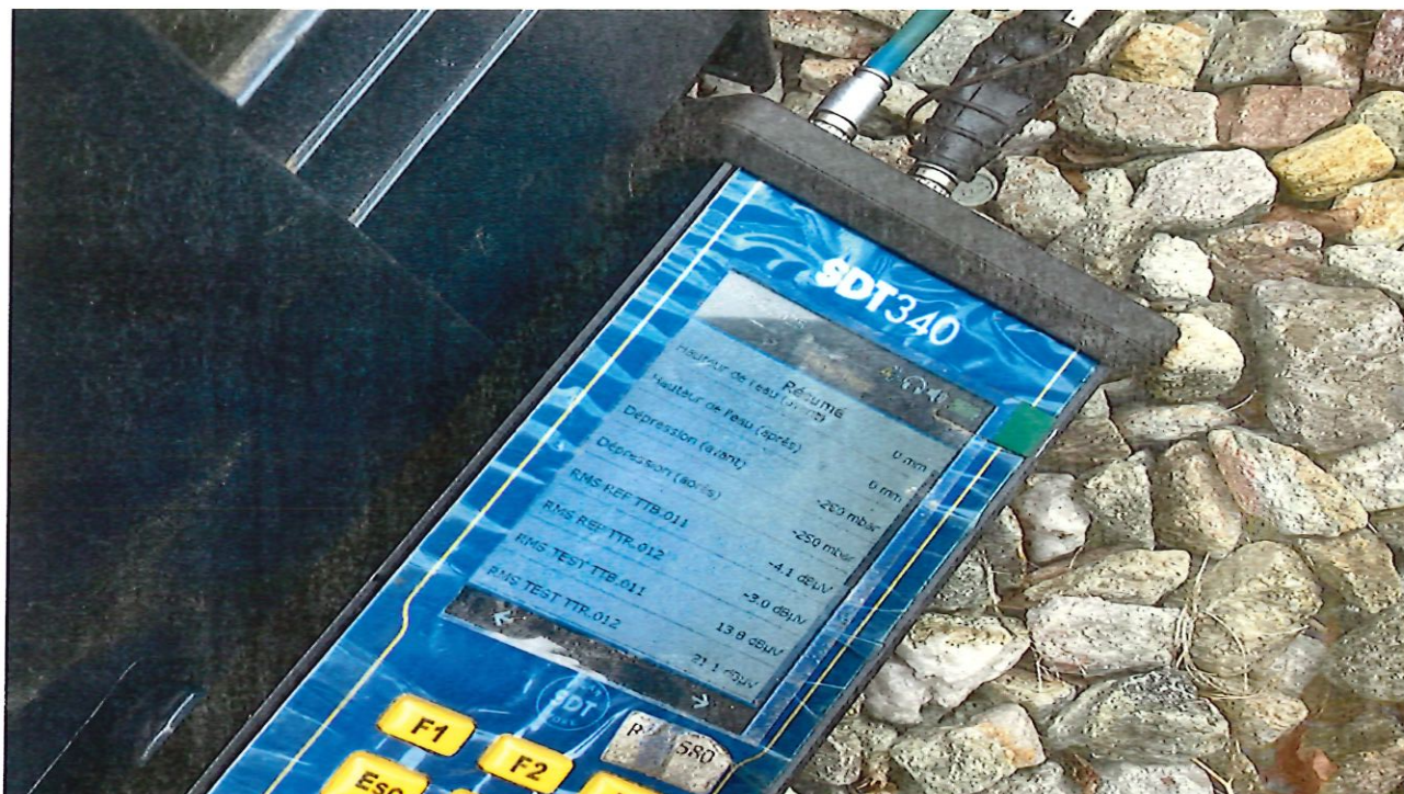
Enregistrement des capteurs avec la fuite calibrée
