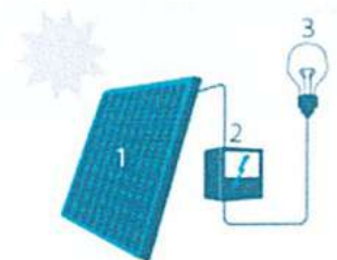
1. Zonnepaneel | 2. Omvormer | 3. Elektrische toestellen
