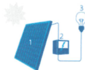
1 Zonnepaneel | 2 Omvormer 3 Elektrische toestellen
