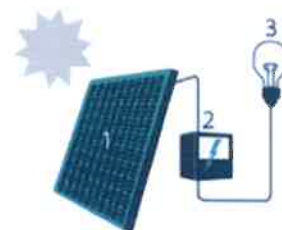
1. Zonnepaneel | 2. Omvormer | 3. Elektrische toestellen
