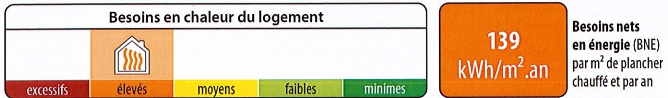
Ces besoins sont les apports de chaleur à fournir par le chauffage pour maintenir constante la température intérieure du logement. Ils dépendent des pertes par les parois selon leur niveau d'isolation thermique, des pertes par manque d'étanchéité à l'air, des pertes par la ventilation mais aussi des apports solaires et des apports internes.
