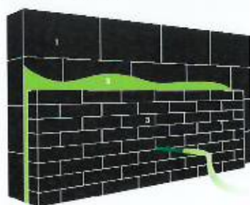
1. Dragende muur | 2. Ingeblazen isolatie | 3. Gevelsteen / gevelbekleding
