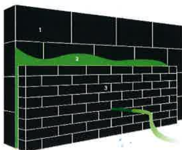
1. Dragende muur | 2. Ingeblazen isolatie | 3. Gevelsteen / gevelbekleding
