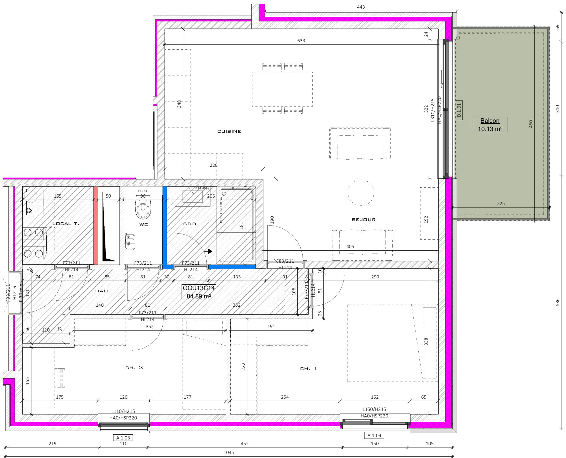
Légende gros-œuvre : Silico-calcaire Voile béton - Colonne Bloc de plâtre Bloc de plâtre hydro Faux-plafond en plâtre isolation brique de parement
