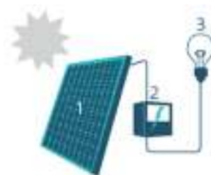
1. Zonnepaneel | 2. Omvormer | 3. Elektrische toestellen
