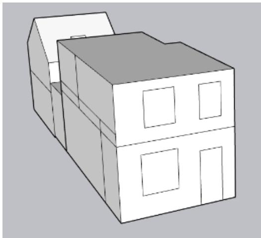
Le volume protégé d'un logement reprend tous les espaces du logement que l'on souhaite protéger des déperditions thermiques que ce soit vers l'extérieur, vers le sol ou encore des espaces non chauffés (cave, annexe, bâtiment mitoyen...). Il comprend au moins tous les locaux chauffés. Lorsqu'une paroi dispose d'un isolant thermique, elle délimite souvent le volume protégé.
