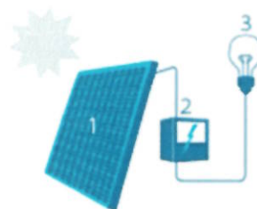
1 Zonnepaneel | 2 Omvormer | 3 Flexibele toevoelen
