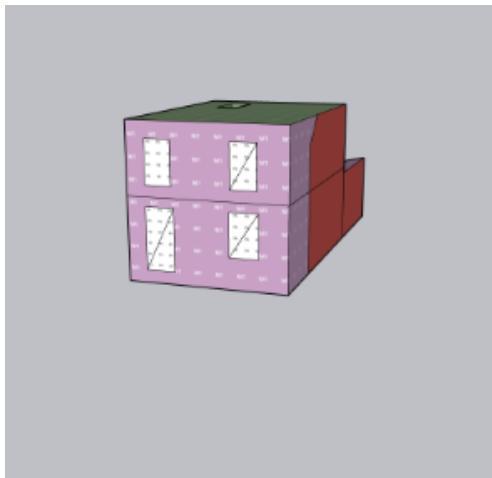
Le volume protégé d'un logement reprend tous les espaces du logement que l'on souhaite protéger des déperditions thermiques que ce soit vers l'extérieur, vers le sol ou encore des espaces non chauffés (cave, annexe, bâtiment mitoyen...). Il comprend au moins tous les locaux chauffés. Lorsqu'une paroi dispose d'un isolant thermique, elle délimite souvent le volume protégé.
