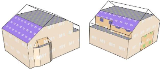
Le volume protégé d'un logement reprend tous les espaces du logement que l'on souhaite protéger des déperditions thermiques que ce soit vers l'extérieur, vers le sol ou encore des espaces non chauffés (cave, annexe, bâtiment mitoyen...). Il comprend au moins tous les locaux chauffés. Lorsqu'une paroi dispose d'un isolant thermique, elle délimite souvent le volume protégé.
