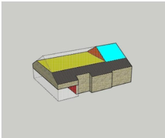
Le volume protégé d'un logement reprend tous les espaces du logement que l'on souhaite protéger des déperditions thermiques que ce soit vers l'extérieur, vers le sol ou encore des espaces non chauffés (cave, annexe, bâtiment mitoyen...). Il comprend au moins tous les locaux chauffés. Lorsqu'une paroi dispose d'un isolant thermique, elle délimite souvent le volume protégé.
