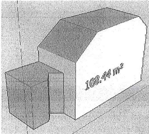
Le volume protégé d'un logement reprend tous les espaces du logement que l'on souhaite protéger des déperditions thermiques que ce soit vers l'extérieur, vers le sol ou encore des espaces non chauffés (cave, annexe, bâtiment mitoyen...). Il comprend au minimum tous les locaux chauffés. Lorsqu'une paroi dispose d'un isolant thermique, elle délimite souvent le volume protégé.
