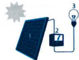
1. Zonnepaneel | 2. Omvormer | 3. Elektrische toestellen
