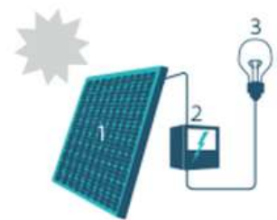
1. Zonnepaneel | 2. Omvormer 3. Elektrische toestellen
