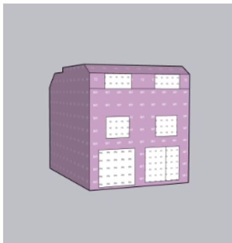
Le volume protégé d'un logement reprend tous les espaces du logement que l'on souhaite protéger des déperditions thermiques que ce soit vers l'extérieur, vers le sol ou encore des espaces non chauffés (cave, annexe, bâtiment mitoyen...). Il comprend au moins tous les locaux chauffés. Lorsqu'une paroi dispose d'un isolant thermique, elle délimite souvent le volume protégé.
