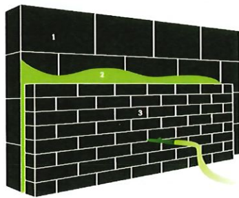
1. Dragende muur | 2. Ingeblazen isolatie | 3. Gevelsteen / gevelbekleding
