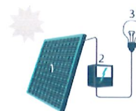
1. Zonnepaneel | 2. Omvormer 3. Elektrische aansluiting
